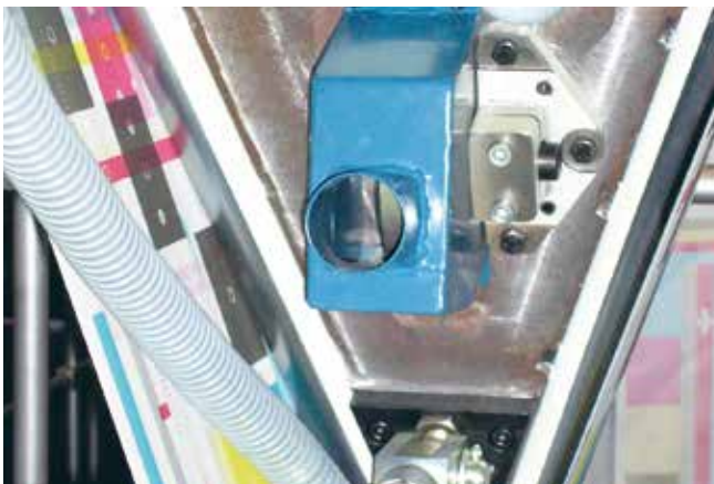
Sugkåpa monterad på skärkniv i tryckpressen
