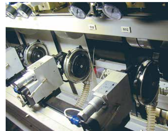
Sugkåpa monterad på skärkniv i tryckpressen
