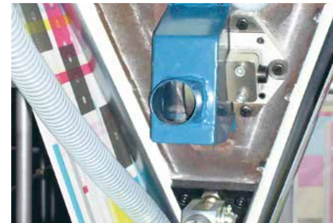
Sugkåpa monterad på skärkniv i tryckpressen
