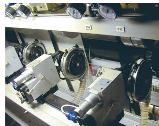
Sugkåpa monterad på skärkniv i tryckpressen
