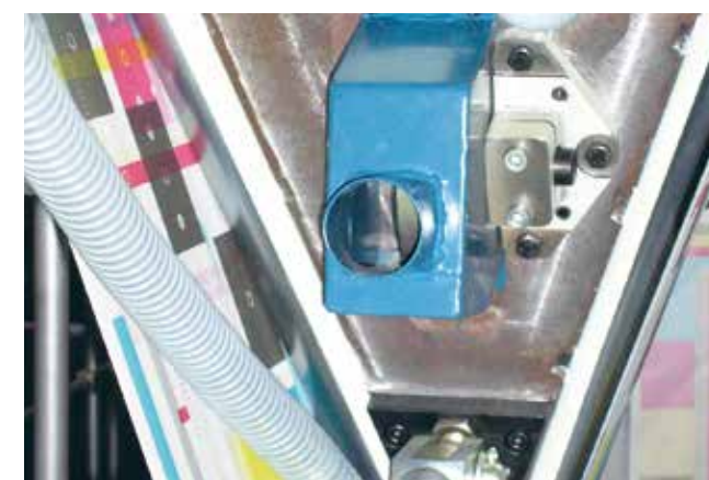
Sugkåpa monterad på skärkniv i tryckpressen
