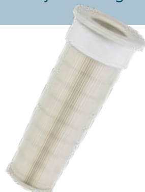
Finfilter polyester - högkvalitativt filter som tål de flesta ämnen. Mycket lämpad för våta miljöer, t ex i mekanisk industri i samband med skärvätskor etc. Ytan är något glattare än hos cellulosafiltret, vilket gör filterrensningen effektivare och livslängden ökar. Filtret är tvättbart.
