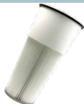
Finfilter, PTFE - polyesterfilter behandlat med PTFE, vilket gör att filterbeläggningen mycket lätt lossnar från filterytan. Filtret används med fördel vid t ex golvslipning. Filtret är tvättbart.
